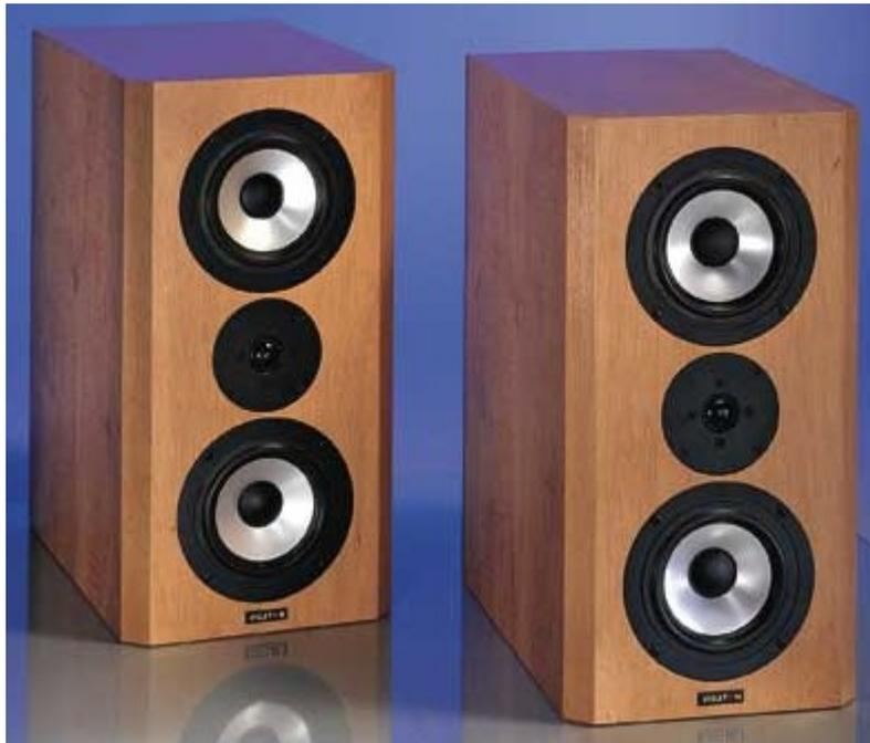
Die [COUplet](#) ist eine Regalbox in D'Appolito Konfiguration. Im Tiefmitteltonbereich arbeiten zwei 13-cm-Chassis vom Typ [AL 130 - 8 Ohm](#). Diese High-End-Lautsprecher können in einem 25-l-Bassreflexgehäuse ihr ganzes Potenzial ausspielen. Großer Hub und geringe mechanische Verluste gewährleisten eine druckvolle und tief reichende Basswiedergabe. Dazu trägt auch das auf der Gehäuserückseite eingebaute Bassreflexrohr [BR 25.50](#) mit seiner strömungsgünstigen Form bei.
