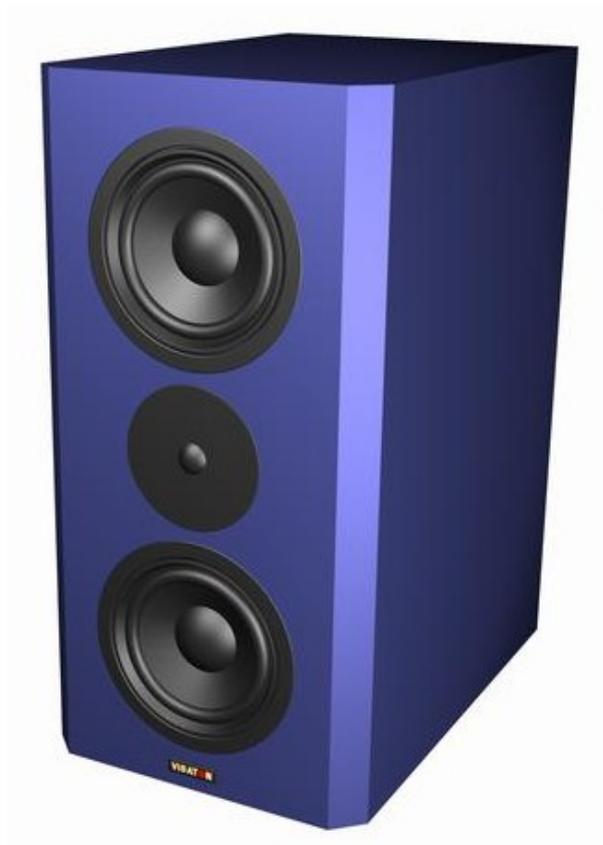
Die [COUplet LIGHT](#) ist eine kompakte Box in D'Appolito-Konfiguration. Sie kann als Regalbox oder frei auf Ständern aufgestellt werden. Im Unterschied zur Original-[COUplet](#) kommen hier zwei [W 130 S - 8 Ohm](#) als Tieftöner zum Einsatz. Der Hochtöner sowie die Gehäuseabstimmung mit dem strömungsgünstigen Bassreflexrohr [BR 25.50](#) wurden unverändert übernommen.
